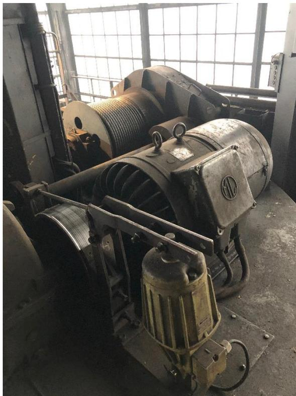
Klassischer Hubwerksantrieb mit Schleifringläufermotor mit elektrohydraulischer Bremse, Vorgelege, Getriebe und zwei Seiltrommeln. Im Einsatz als Hüttenkran 143 bei BGH.
